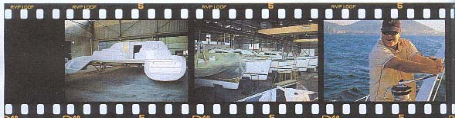
Le pont d'un Leopard 47 attend la pose des principaux organes, avant d'être soudé aux coques.
