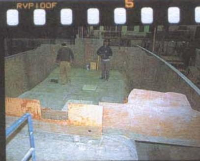
*La coque nue, qui a pris place dans la chaîne de production, est inspectée avant de recevoir le moteur.*
