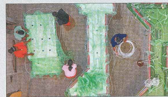
L'essentiel des 125 pièces moulées qui composent les grands modèles est réalisé en infusion sous vide.
