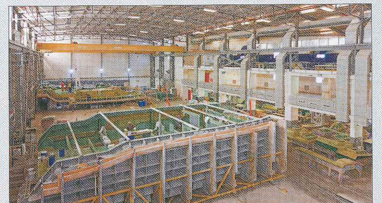
Le moulage du 53 PC sur le site de production dédié à la lamination. Les cloisons structurales sont posées avant de déplacer la double coque.
