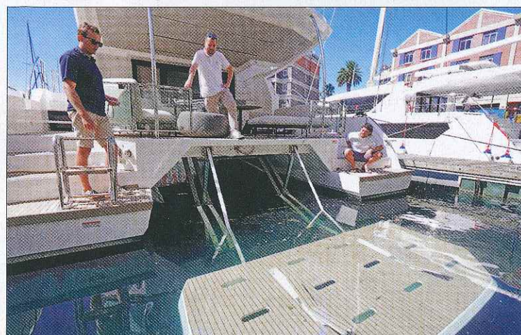
Le système électrique de mise à l'eau est un brevet Leopard. Les supports d'annexe ont été améliorés pour faciliter la manœuvre.
